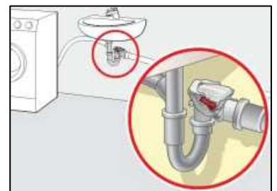
Abb.: Mini-Rückstausicherung am Siphon-Ablauf (Quelle: Kessel)
