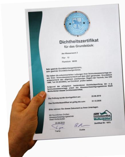
Zur Erlangung des Zertifikates muss gemäß der DIN 1986 Teil 30 die **gesamte** erdverlegte und schmutzwasserführende Grundstücksentwässerungsanlage (**GEA**) auf Ihrem Grundstück, d.h. bis zu Ihrer Grundstücksgrenze, geprüft werden. Die Prüfung muss von Ihnen über einen entsprechenden Fachbetrieb beauftragt werden.
